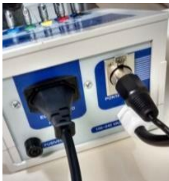
Figura 5 - Plugue de tensão e cabo de teste conectados ao analisador de segurança elétrica.
