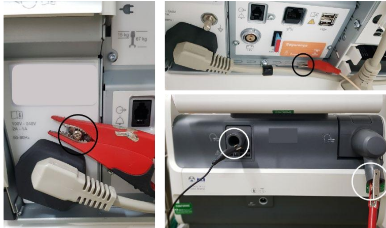
Figura 4 - Cabos de teste conectados a ventilador UTI para realização de teste de segurança elétrica.
