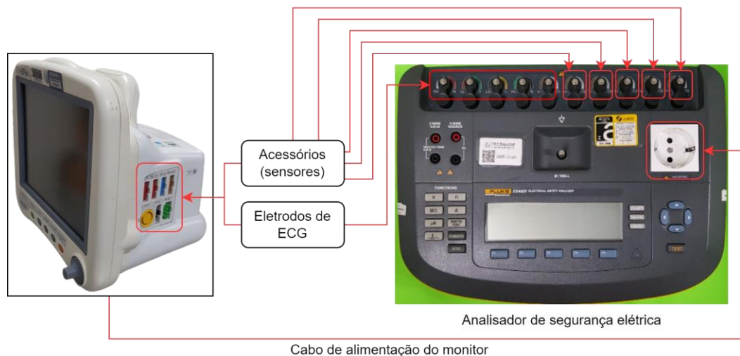
Figura 4 - Indicação de conexões para realização de teste de segurança elétrica em monitor fisiológico multiuso.
