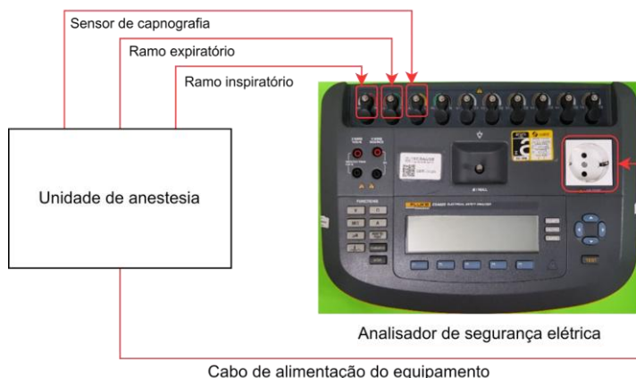
Figura 5 - Indicação de conexões entre unidade de anestesia e analisador de segurança elétrica.
