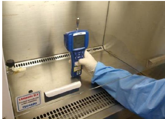
Figura 10 - Posicionamento do contador de partículas para o teste de concentração de partículas.
