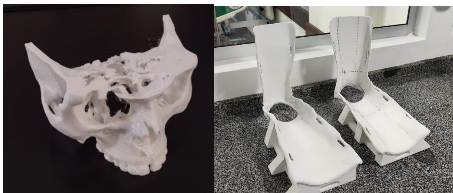
Figura 02: Modelo de planejamento cirúrgico de um crânio (esquerda), órtese de membro inferior para paciente acamado (direita).
