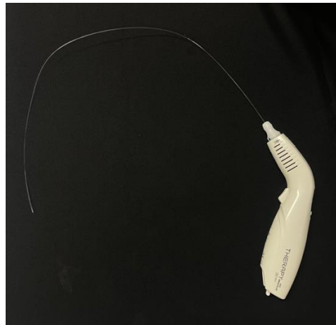
Figura 1: Protótipo de fibra alongada de laser acoplada a um equipamento de laser de baixa potência da TherapyXT DMC® (Fonte: os autores, 2023)
