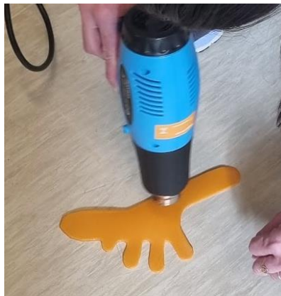
Figura 2- Utilização do soprador térmico para modelagem.
