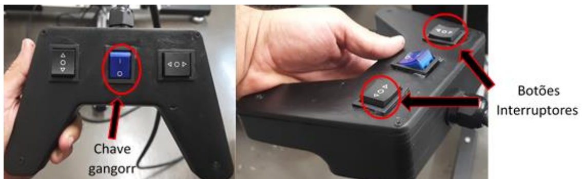
Figura 5 – Controle do sistema elétrico.
