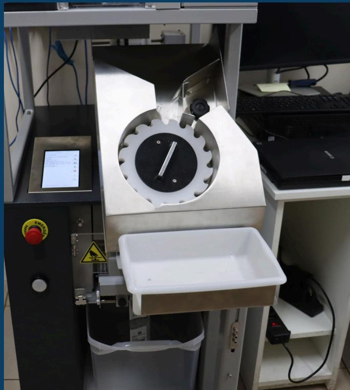
A nova máquina de unitarização de medicamentos do HFA modernizou o processo de fracionamento e embalagem de comprimidos e cápsulas, garantindo maior segurança, padronização das doses e rastreabilidade completa dos medicamentos. A tecnologia reduz falhas humanas e aumenta a produtividade, mantendo o cumprimento rigoroso das normas sanitárias.
