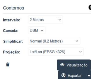
Figura 122 Configuração de curvas de nível.
