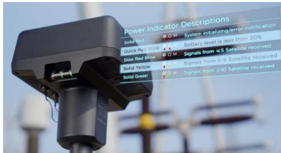
Figura 30 Situação de operação do RTK
