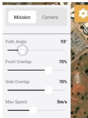
Figura 52 Configurações de voo no 3DsurveyPilot
