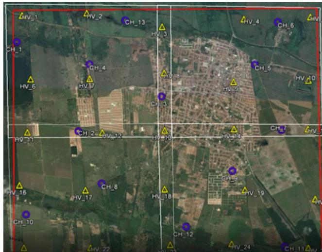
*Figura 42 Exemplo de distribuição de pontos de checagem e controle no terreno.*
