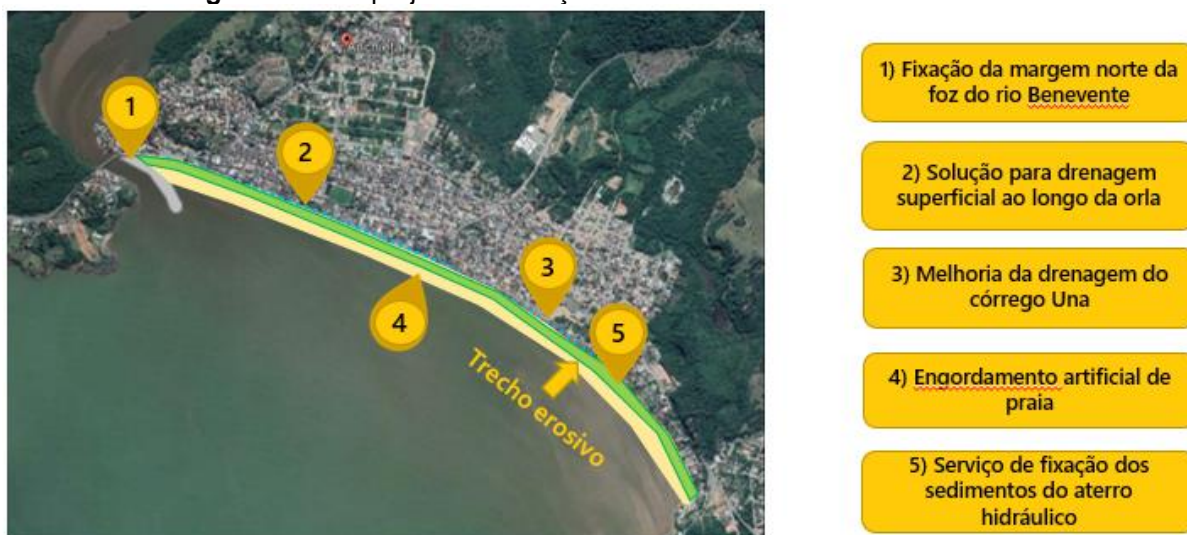
Figura 40: Anteprojeto - contenção da erosão costeira da Praia Central.
