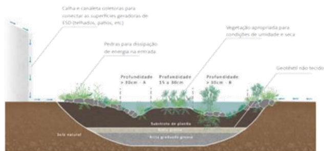
Figura 4: Figura- Jardim de chuva, corte esquemático. Fonte: Guajava, 2023
