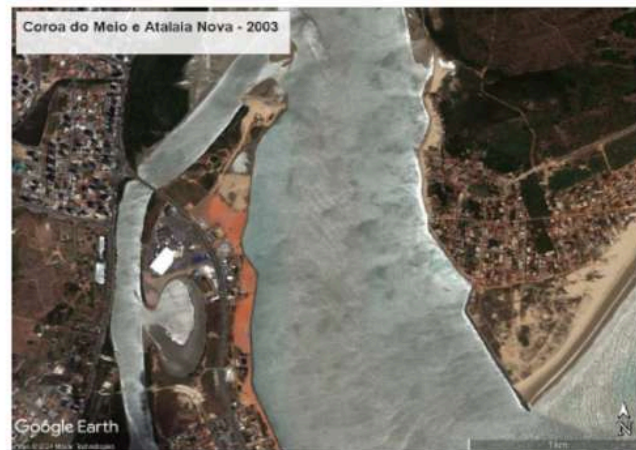
Figura 25 - Estuário do Rio Sergipe entre a Atalaia Nova e a Coroa do Meio após forte evento erosivo. Nota-se o colapso da região do "Bico do Pato", o completo desaparecimento da sedimentação nos trechos finais do enrocamento da Atalaia Nova e deposição de sedimentos na região da Atalaia.
