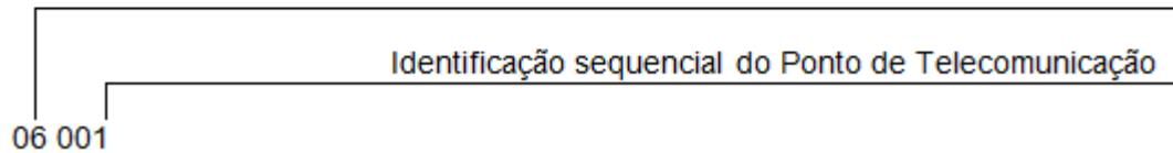
Todos os cabos de lógica deverão ser identificados com o nome do ponto de telecomunicação, em no mínimo 4 pontos, sendo 2 nas extremidades e 2 em pontos intermediários. contados a partir do Armário de Telecomunicação. Todos os PATCH PANEL, PATCH CABLES e DEVICE CABLE, deverão ser identificados na suas extremidades próximas ao conector modular 8 vias (RJ45 fêmea)
