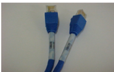
Modelo de identificação dos PATCH CABLES e DEVICE CABLE
