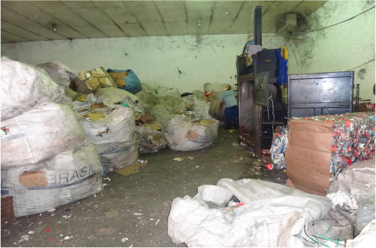
Prensa enfardadeira sem proteção das partes móveis
