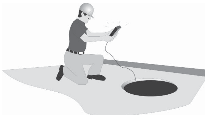
Figura 71 Monitoramento de gases
