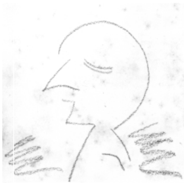
Figura 1. Para propósitos de demonstração, este papel com colagem de gelatina e sobre o qual está um desenho em pastel foi exposto ao ar em um ambiente interno normal e, posteriormente, colocado em uma câmara de umidificação com nível de umidade relativa superior a 90%. O mofo foi visível após três dias. O papel foi removido da câmara depois de 10 dias e colocado em um ambiente em que a umidade relativa era de 50%. Em uma hora, o mofo ativo, que estava em crescimento, começou a enrugar e se enfraquecer; não foi observado qualquer crescimento adicional.
