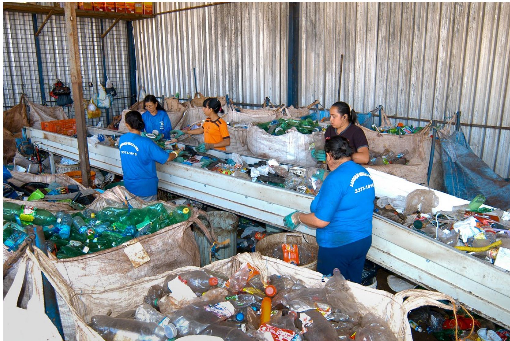
Figura 6: Esteira de triagem de materiais na cooperativa de catadores Recicle a Vida, em Ceilândia (DF).
