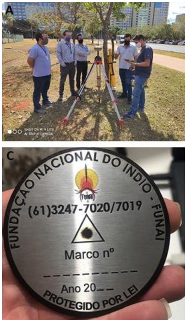
Fotografia do Receptor GNSS RTK adquirido pela FUNAI em 2020 (A), bem como do RPA Asa Fixa Arator XMOBOTS homologado pela ANAC para voos acima de 400 fts (B), além das plaquetas de aço inoxidável para utilização em atividades de georreferenciamento (C) e também marco de ferro galvanizado para utilização em georreferenciamento
