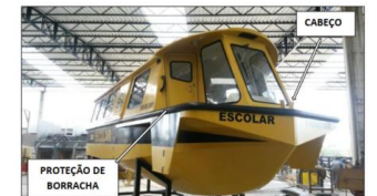
Figura 1 – Condição de recebimento do casco, proteção lateral e cabeço.
