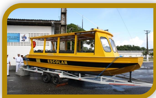
Figura 12 – Lancha Escolar projetada pela Marinha para o Transporte Escolar Rural. Fonte: FNDE/CEFTRU (2011)
