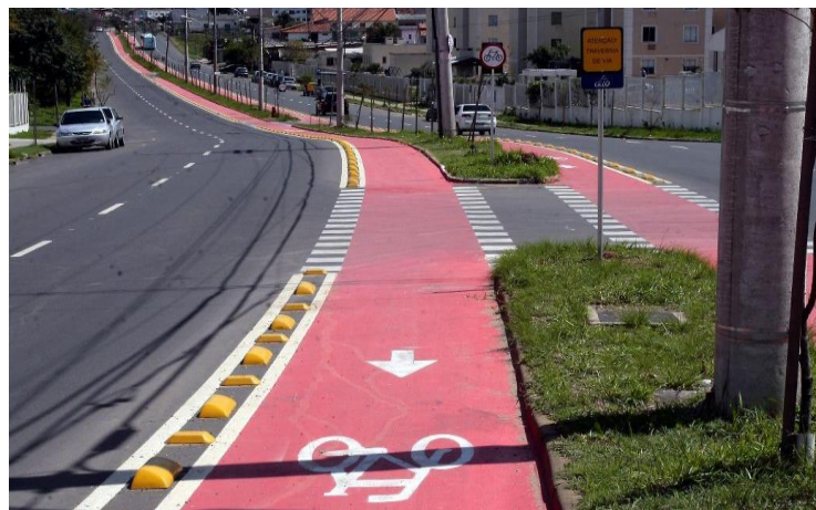
Figura 84 – Ciclovia delimitada por tachões
