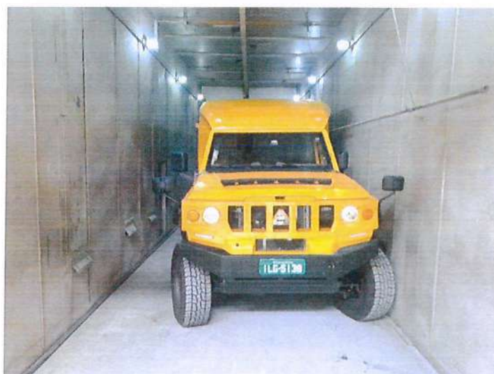
Figura 04 – Veículo posicionado em estufa para teste
