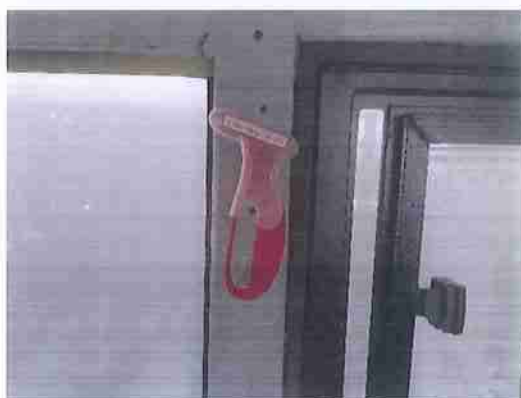
Figura 05 – Martelo na lateral direita do salão (região traseira próximo ao DPM)
