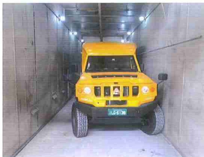
Figura 04 – Veículo posicionado em estufa para teste
