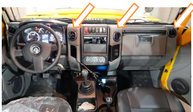
Figura 8: Ventilação lateralizada para não influenciar no ensaio
