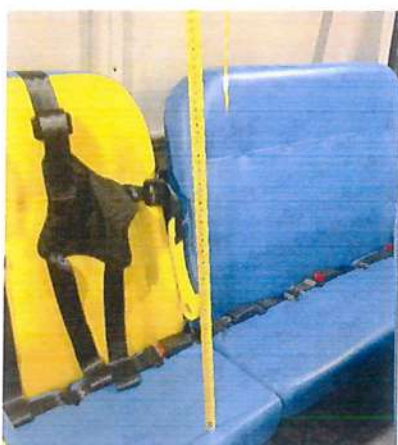
Figura 02 – Medição da altura dos sensores termopar (600 mm)
