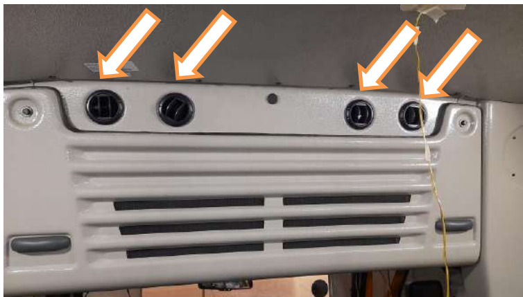
Figura 9: Ventilação lateralizada para não influenciar no ensaio
