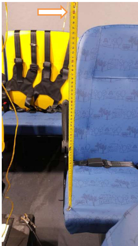
Figura 6: Termopares interior em altura de 600mm
