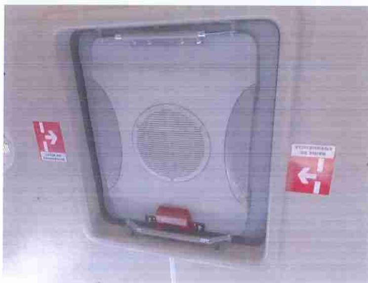
Figura 10 – Saída de emergência na escotilha do teto
