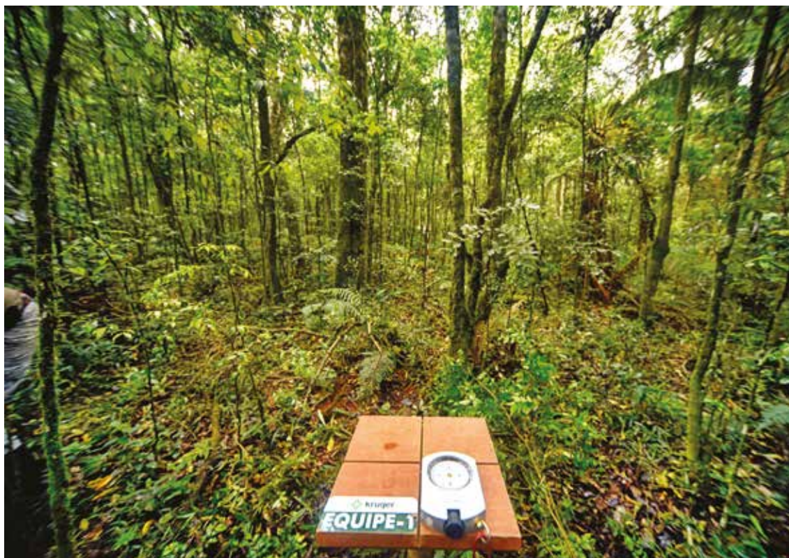
Marcação do ponto central de um conglomerado do IFN-PR, com auxílio de cruzeta e bússola.
