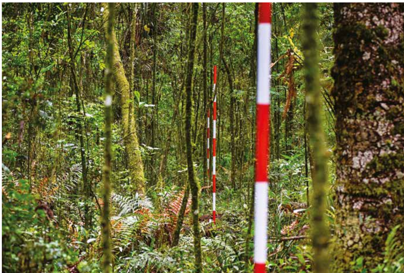
Balizamento para delimitação de conglomerado do IFN-PR. Foto: Acervo de imagens SFB
