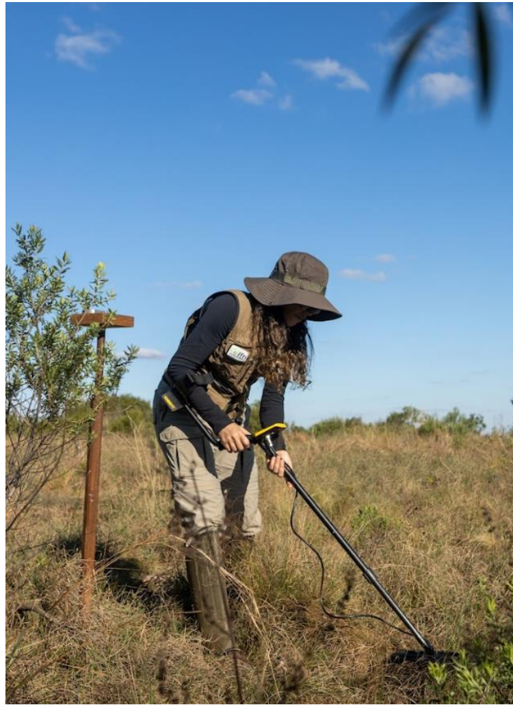
Figura 8 – Equipe de Controle de Qualidade de Campo utilizando detector de metais para encontrar o marco de alumínio instalado pela equipe da empresa, visando avaliar a materialização do Ponto Central (2ª Etapa).
