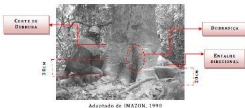
Figura 14: Corte Direcional das Árvores.
