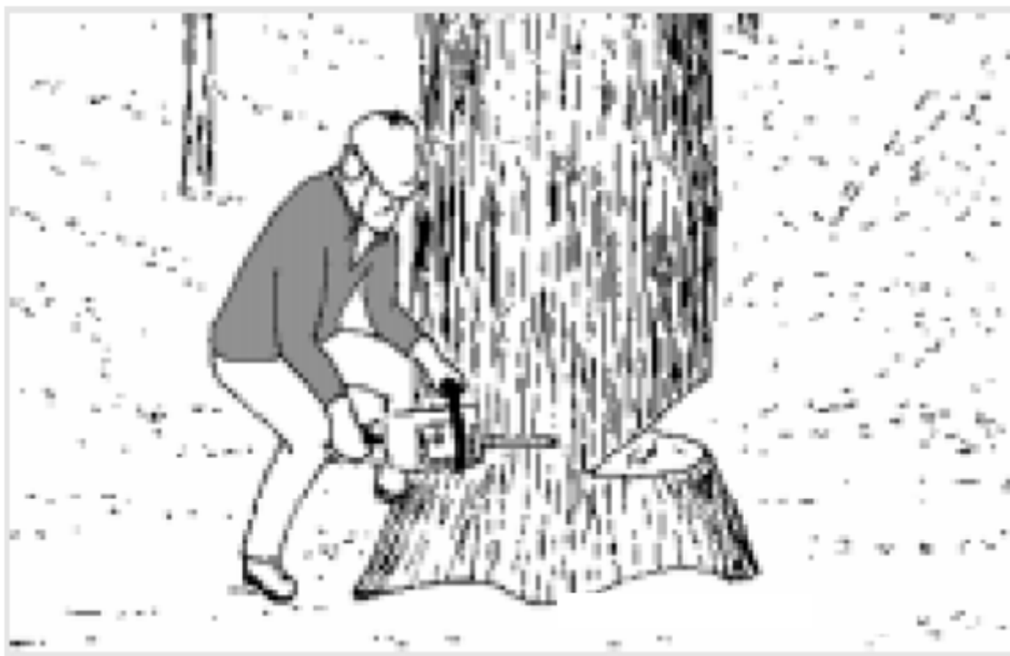
Figura 48. Posição correta para o corte da árvore
