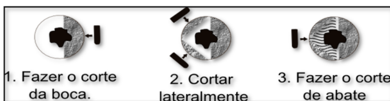
Figura 42 – Passos para corte de árvores com oco. (Fonte: adaptado de IMAZON (1998)).
