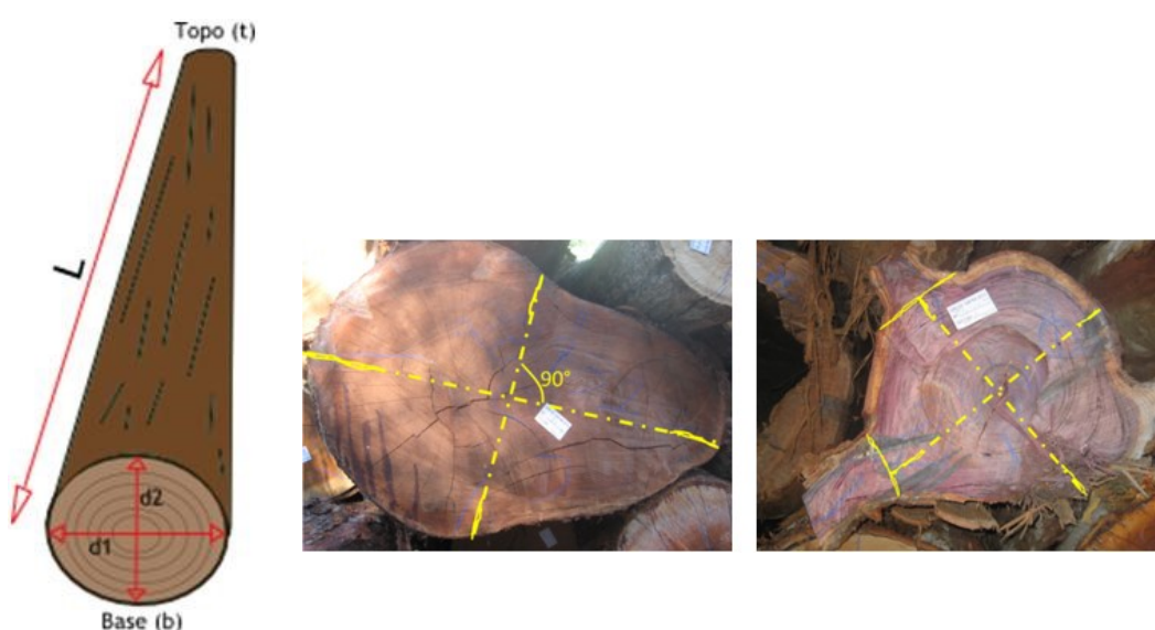
Figura 51. Medição em cruz do diâmetro da tora
