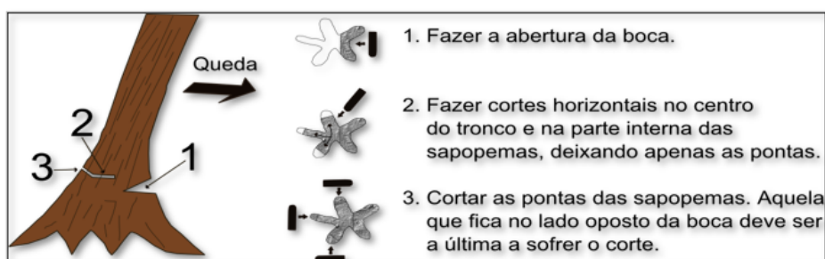
Figura 45 - Corte de árvores inclinadas e com sapopemas. (Fonte: adaptado de IMAZON (1998)).
