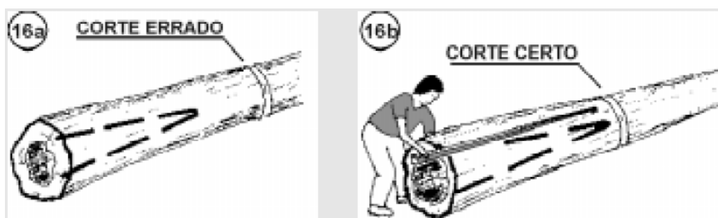
Figura 34 - Teste da vara para estimar oco. Fonte: Floresta para Sempre, IMAZON (1998).
