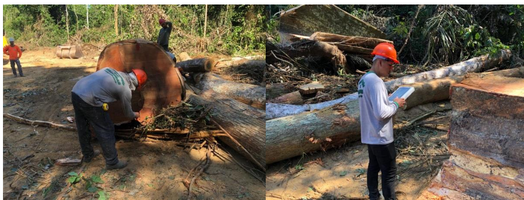
Figura 55: Pintura dos Pontos de Medição das Toras no Pátio Florestal (Esquerda) e Lançamento das Medições no SGF (modo off-line) para posterior impressão das Etiquetas e fixação na tora (Topo e Base).
