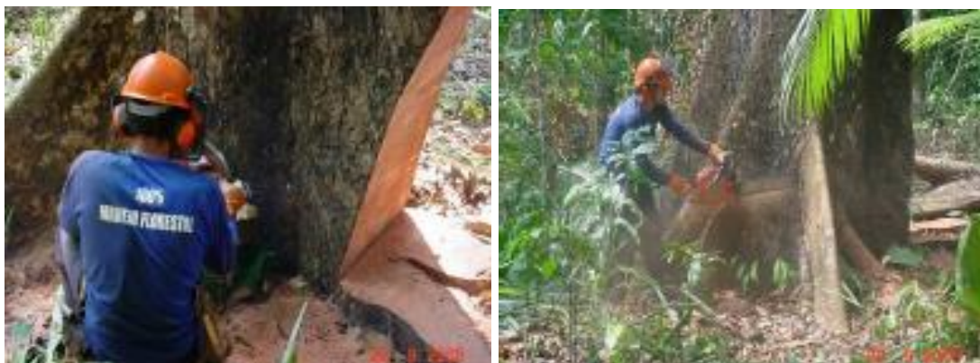
Figura 46: Corte Horizontal do Tronco (Esq.) e Corte de Derruba (Dir.).
