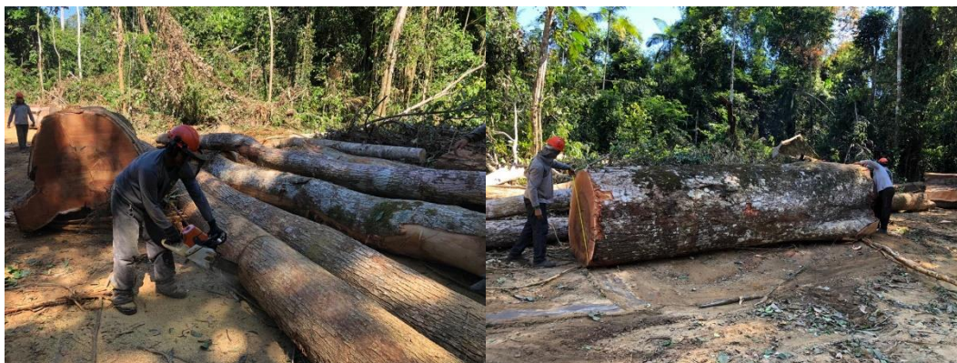
Figura 54: Traçamento das Toras no Pátio Florestal (Esquerda) e Medições e Pintura dos Pontos de Medição das Toras no Pátio Florestal (Direita).
