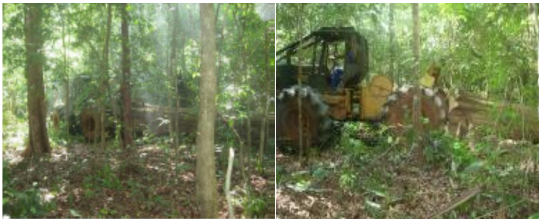
Figura 49: Arraste com Skidder.
