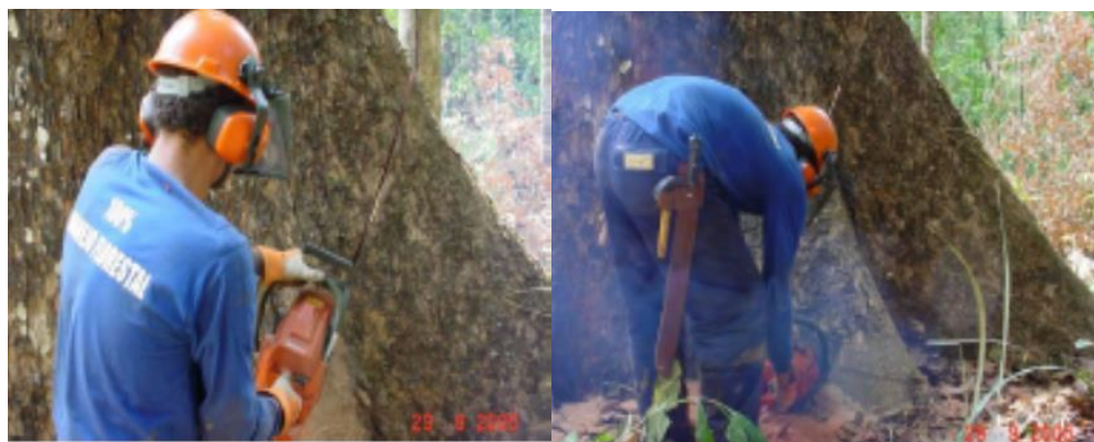
Figura 45: Corte vertical das Sapopemas (Esq.) e Corte Horizontal das Sapopemas (dir.).
