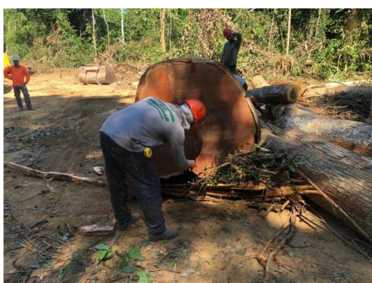
Figura 36: Pintura dos Pontos de Medição das Toras no Pátio Florestal (Esquerda) e Lançamento das Medições no SGF (modo off-line) para posterior impressão das Etiquetas e fixação na tora (Topo e Base).
