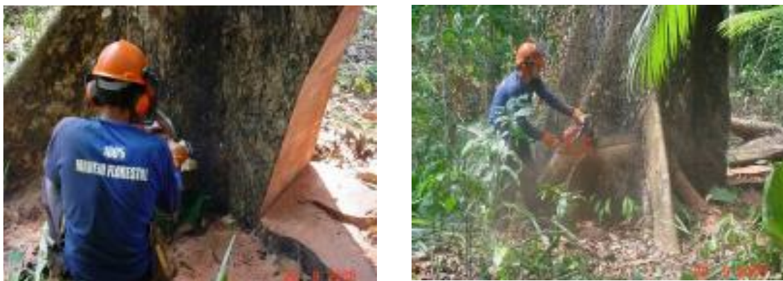
Figura 26: Corte Horizontal do Tronco (Esq.) e Corte de Derruba (Dir.).
