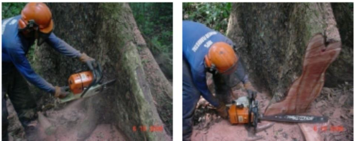
Figura 18: Corte Direcional das Árvores.
