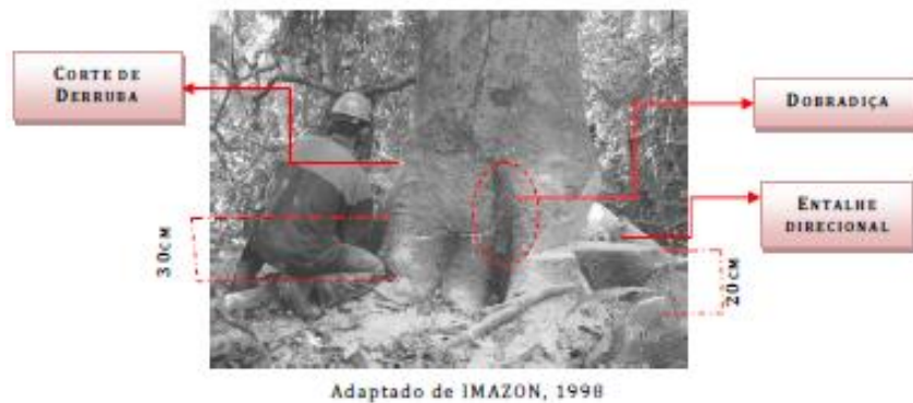
Figura 17: Corte Direcional das Árvores.
