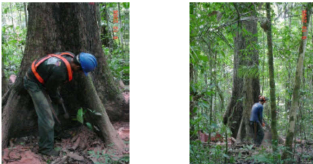
Figura 23: Uso de cunhas (esq.) e corte de derruba (dir.).
