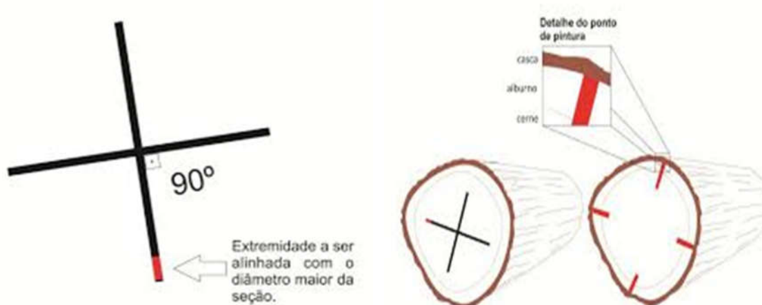
Figura 32: Marcação do do ponto de medição do diâmetro cruzeta em toras uniformes.
