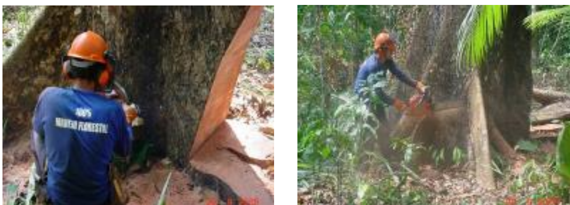
Figura 32. Corte horizontal do tronco (esq.) e corte de derruba (dir.).
