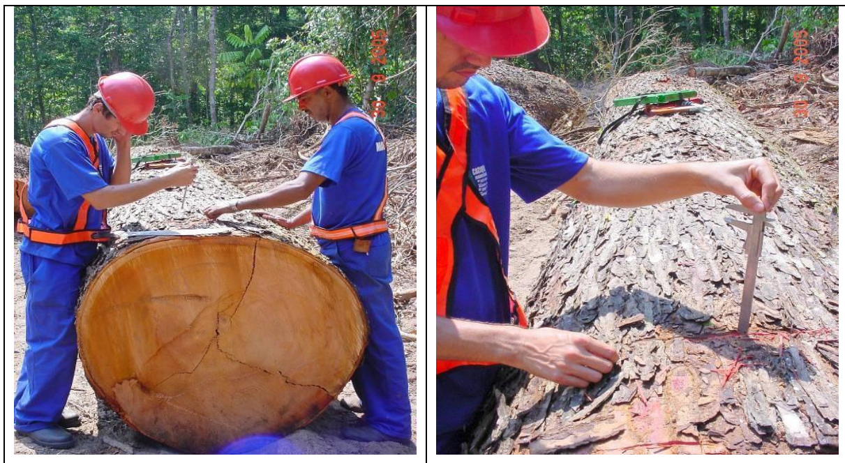
Figura 17. Mensuração do diâmetro (esq.) e mensuração da espessura da casca (dir.)
