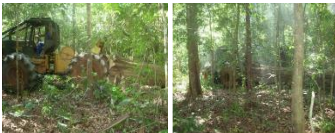
Figura 34. Arraste com skidder.
