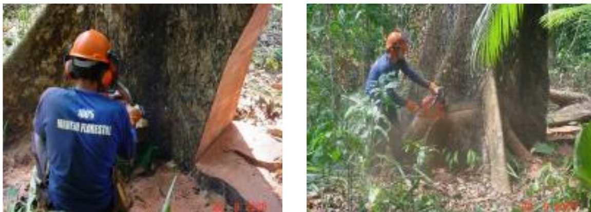
Figura 30. Corte horizontal do tronco (esq.) e corte de derruba (dir.).
