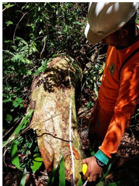
Figura 83: Medições das Galhada para Ajuste da Equação de Volume dos Resíduos.
