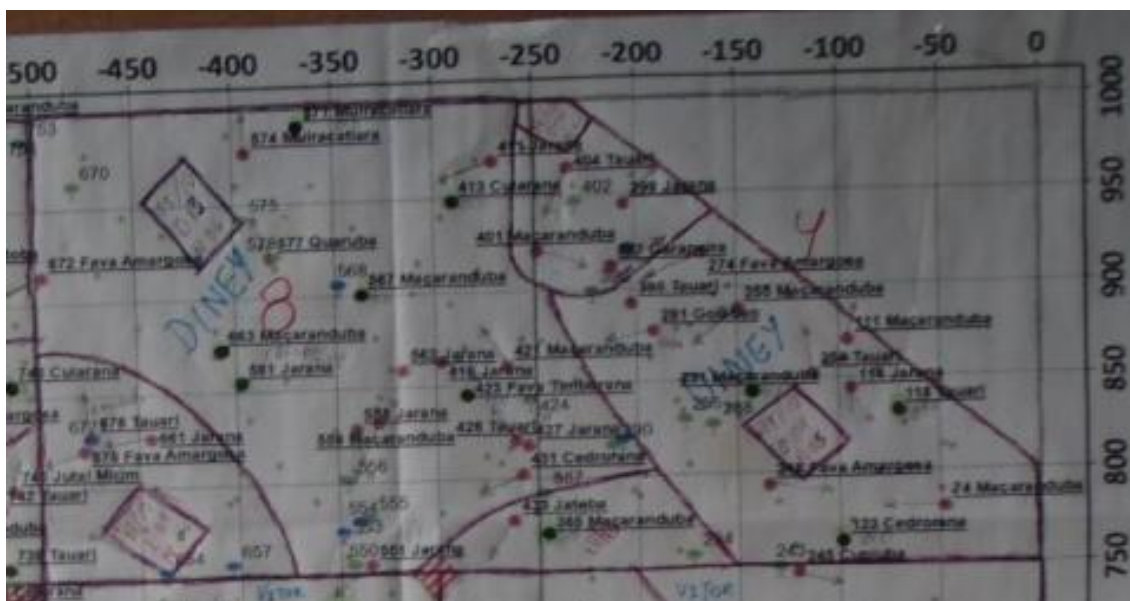
Figura 56: Exemplo de Mapa de Corte com a Direção de Queda das Árvores.
