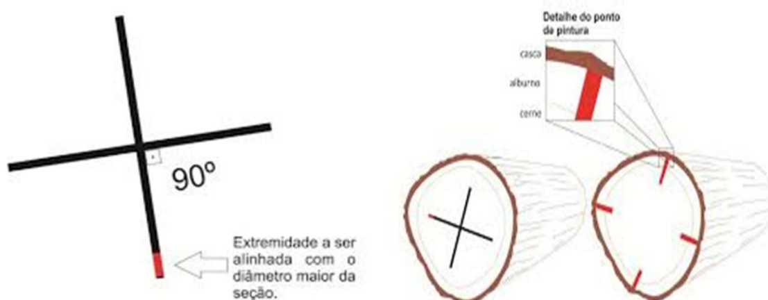
Figura 68: Marcação do ponto de medição do diâmetro cruzeta em toras uniformes.
