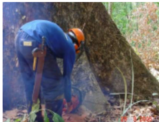
Figura 60: Corte vertical das Sapopemas (Esq.) e Corte Horizontal das Sapopemas (dir.).
