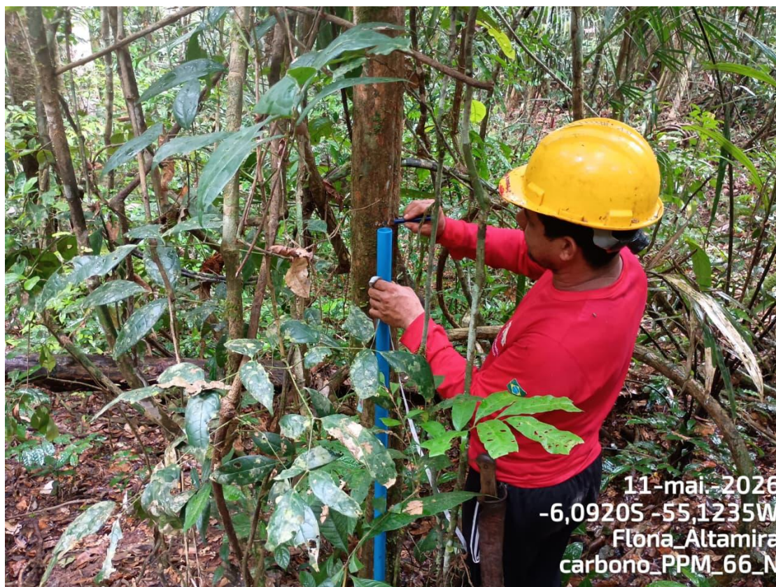
Figura 88: Medição do CAP com utilização de gabarito de PVC (1,30m).
