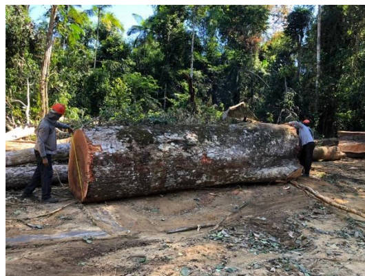
Figura 37: Traçamento das Toras no Pátio Florestal (Esquerda) e Medições e Pintura dos Pontos de Medição das Toras no Pátio Florestal (Direita).
