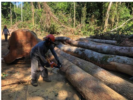
Figura 37: Traçamento das Toras no Pátio Florestal (Esquerda) e Medições e Pintura dos Pontos de Medição das Toras no Pátio Florestal (Direita).
