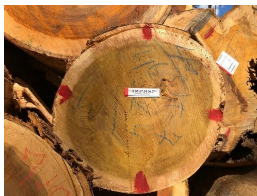
Figura 39: Exemplo de Controle de Custódia: Tora com os pontos de medição (cruzeta), Etiquetas de Controle: 1ª Etiqueta (Superior), 2ª Etiqueta (Centro) e 3ª Etiqueta (Centro-Inferior) (Esquerda) e 4ª Etiqueta (Inferior/Base) (Direita).
