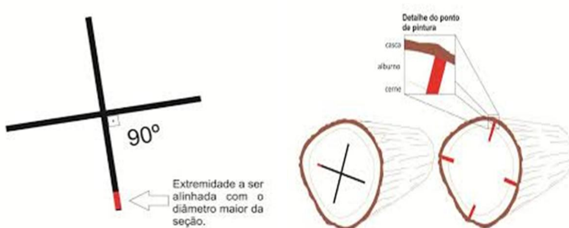
Figura 35: Marcação do ponto de medição do diâmetro cruzeta em toras uniformes.
