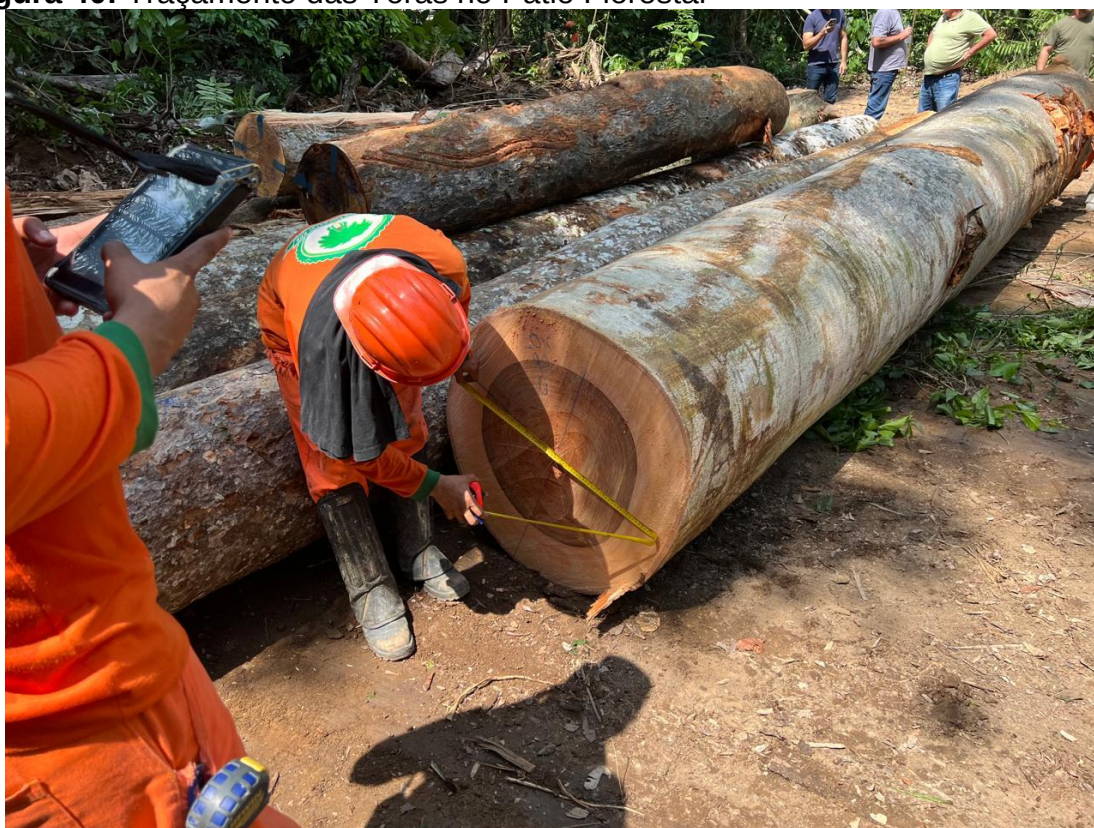
Figura 41: Medições dos Diâmetros (Cruzeta) da Tora
