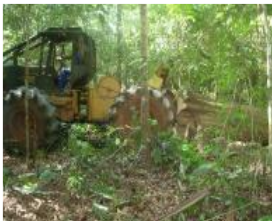
Figura 32: Arraste com Skidder.
