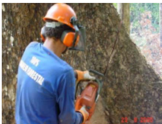
Figura 25: Corte vertical das Sapopemas (Esq.) e Corte Horizontal das Sapopemas (dir.).
