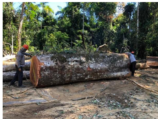
Figura 35: Traçamento das Toras no Pátio Florestal (Esquerda) e Medições e Pintura dos Pontos de Medição das Toras no Pátio Florestal (Direita).
