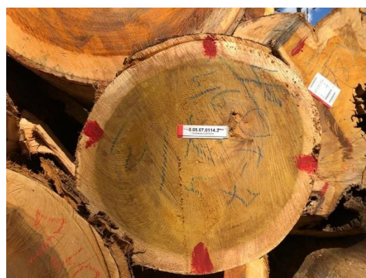
Figura 37: Exemplo de Controle de Custódia: Tora com os pontos de medição (cruzeta), Etiquetas de Controle: 1ª Etiqueta (Superior), 2ª Etiqueta (Centro) e 3ª Etiqueta (Centro-Inferior) (Esquerda) e 4ª Etiqueta (Inferior/Base) (Direita).
