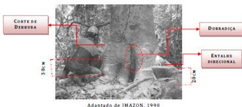
Figura 17: Corte Direcional das Árvores.
