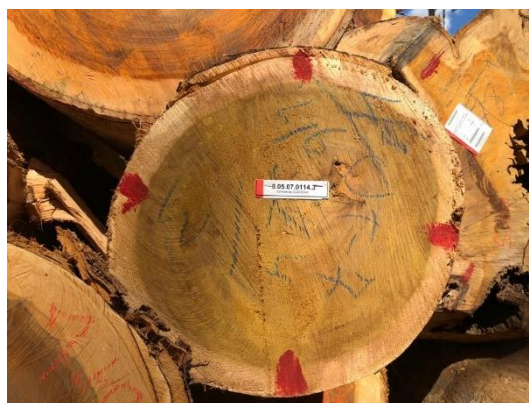
Figura 37: Exemplo de Controle de Custódia: Tora com os pontos de medição (cruzeta), Etiquetas de Controle: 1ª Etiqueta (Superior), 2ª Etiqueta (Centro) e 3ª Etiqueta (Centro-Inferior) (Esquerda) e 4ª Etiqueta (Inferior/Base) (Direita).
