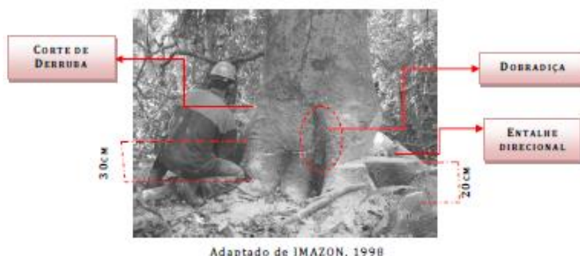
Figura 17: Corte Direcional das Árvores.
