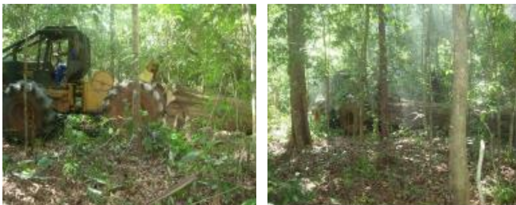
Figura 32. Arraste com skidder.
