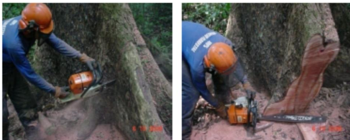
Figura 20: Corte Direcional das Árvores.
