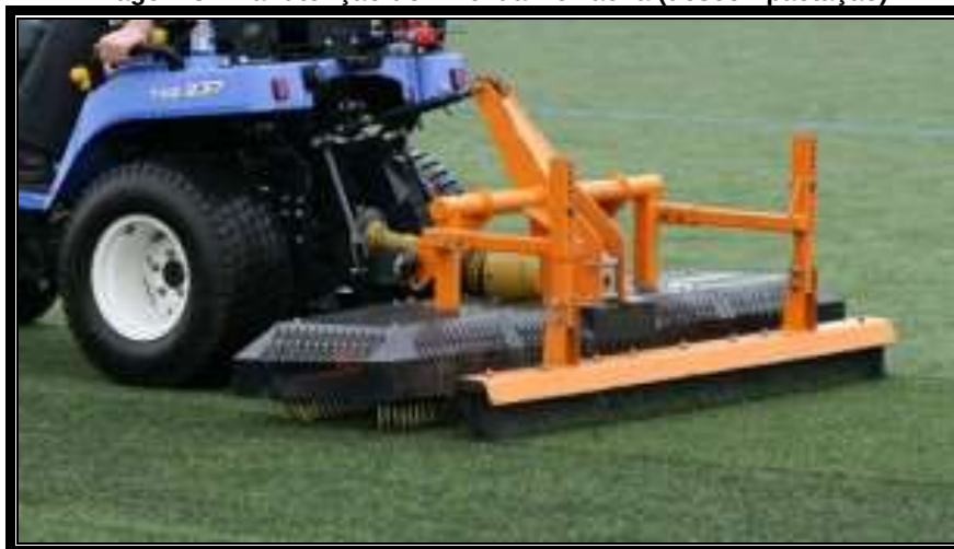
Imagem 8 - Manutenção do nível da Borracha (descompactação)
