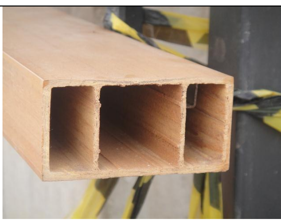
Foto 8 – Detalhe da régua de acabamento - 26 de setembro de 2014.
