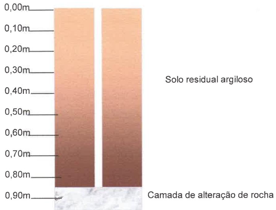
**Fig. 05:** Perfil esquemático em S 05, na margem direita com profundidade de 0,85m.
