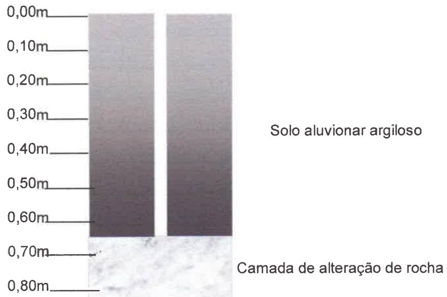
**Fig. 01:** Perfil esquemático em S 01, na margem esquerda com profundidade de 0,65m.
