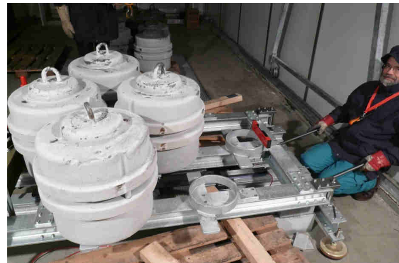
Sistema de Carregamento com Pesos Certificados (cada de 500Kg) – Instalação em Câmara Climática
