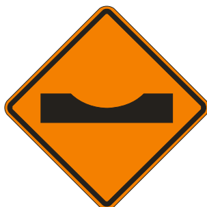
Figura 9 - Sinal A-19: Depressão
