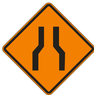
Figura 10 - Sinal A-21a: Estreitamento de pista ao centro
