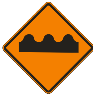
Figura 7 - Sinal A-17: Pista irregular
