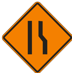
Figura 12 - Sinal A-21c: Estreitamento de pista à direita
